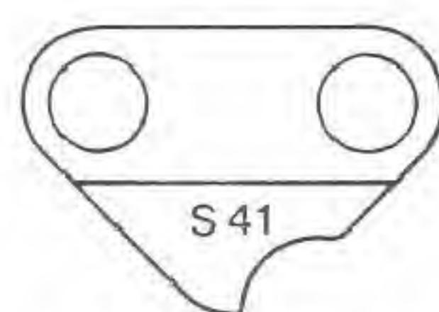
Sl. 111 — Pogonska spojnica sa oznakom tipa lanca
